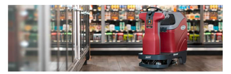
L'autolaveuse Minuteman RoboScrub 20 avec système BrainOS® travaille dans des environnements complexes et réels. La machine est conçue pour travailler en toute sécurité et efficacement au milieu des employés ou des passants et peut toujours être utilisée manuellement dans certaines situations.
